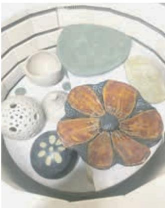
Die Farbglasur wird mit 1.230 °Celsius in einem speziellen Ofen eingebrannt.
